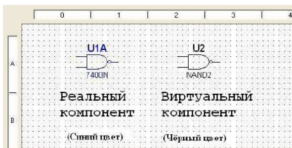
Рис. 10. Изображение реального и виртуального компонента на рабочем поле
