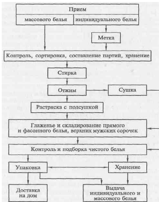
Рисунок 1 – Блок-схема технологии обработки белья на фабриках-прачечных
