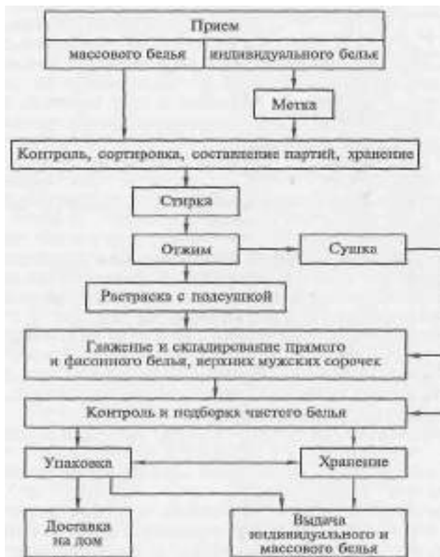
Рисунок 1 – Блок-схема технологии обработки белья на фабриках-прачечных
