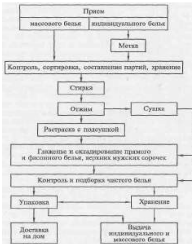
Рисунок 1 – Блок-схема технологии обработки белья на фабриках-прачечных
